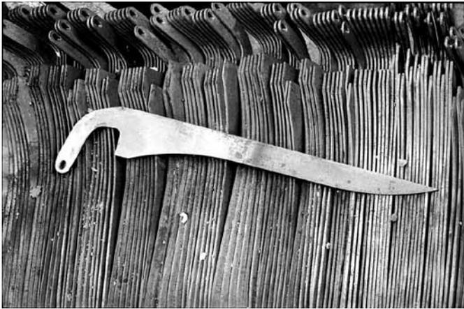
Fig. 2. Le couteau de faux dans son premier état : forgeage et boutonnage ont été réalisés avec l'emboutisseuse.
