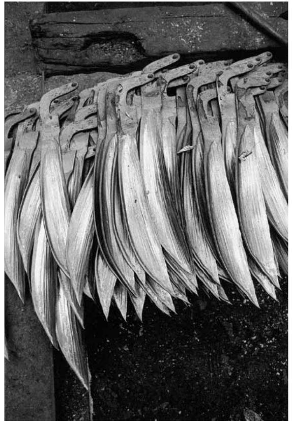
Fig. 4. Le couteau après le premier passage sous le martinet : l'avant (partie pointue) est étiré, mais pas encore l'arrière ni le milieu.
