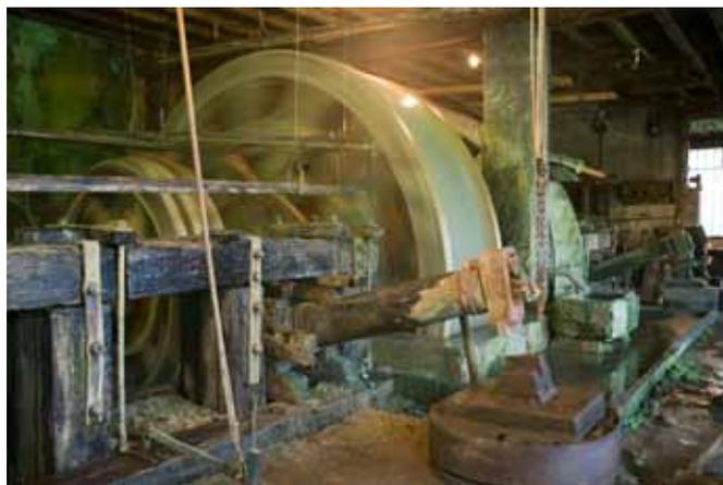
*Martinet de forge en fonctionnement. Les martinets servaient à aplatir le métal pour fabriquer les lames de faux. Ils sont actionnés, encore aujourd'hui, grâce à la seule force de l'eau, tombant dans les godets des grandes roues de 5 mètres de diamètre.*
