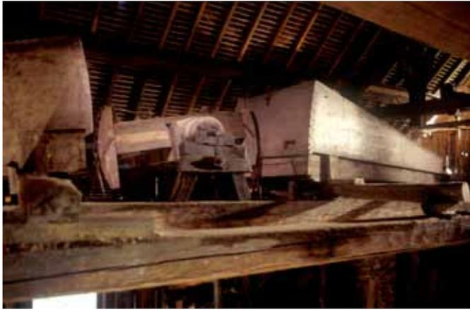
Machine soufflante. Ces grands soufflets, de 3,50 m de long chacun, sont uniques en Europe. Ils sont entièrement en bois et fonctionnent, aujourd'hui encore, grâce à une grande roue hydraulique.
