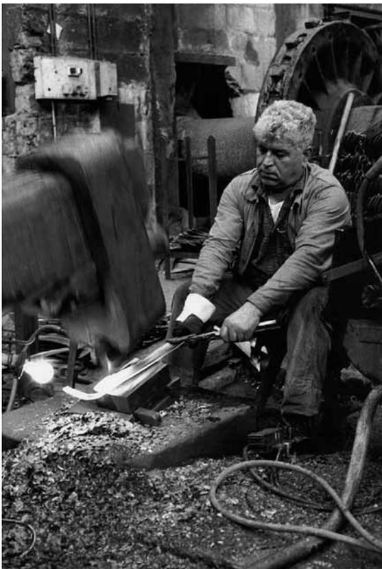
Fig. 3. Le platinage : après chauffage à blanc dans le four, la lame est frappée au martinet.
